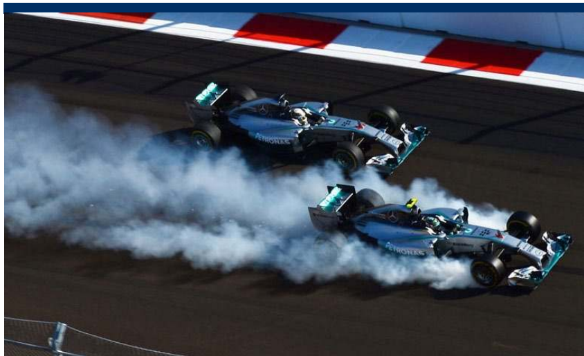
Hình ảnh xe của tay đua Nico Rosberg (xe phía trước) bị khoá bánh tại góc của số 1 trong Chặng đua F1 Russian Grand Prix 2014.
