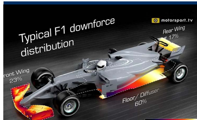
Hình minh họa các bộ phận trên xe đua với các tỉ lệ tạo ra lực nén xuống tương ứng.
